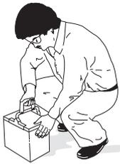
Batterien sind schwer. Beim Transportieren von Batterien sachgemäße Hebemethoden benutzen. Die Batterie stets mit einer handelsüblichen Batterie-Hebevorrichtung heben. Darauf achten, daß die Batterien beim Aus- oder Einbau nicht gekippt werden; verschüttete
