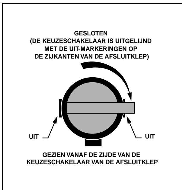
Figuur 12 Brandstofafsluitklep – gesloten stand
